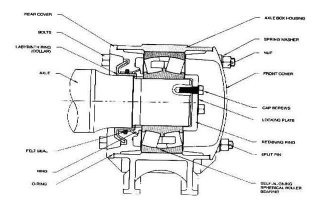
**DIRECT MOUNED ROLLER BEARING ARRANGEMENT**
